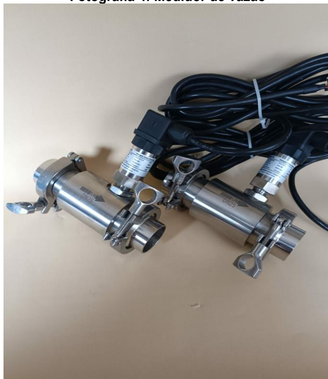
Fotografia 4: Medidor de vazão
