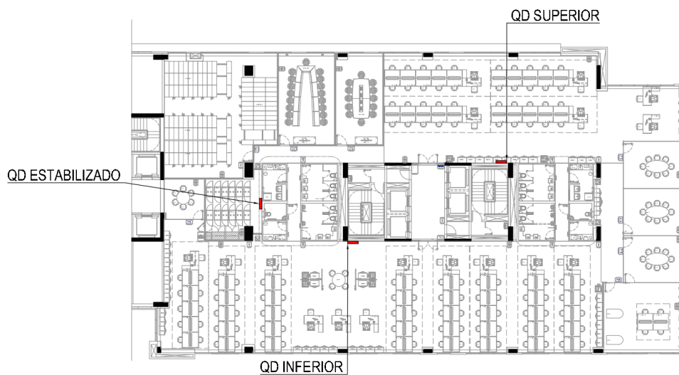
Figura 31 – Posições dos quadros elétricos após deslocamento para parede mais próxima.
