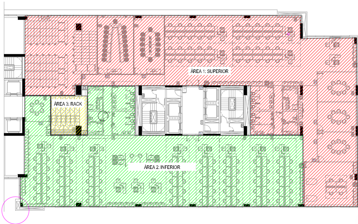
Figura 29 – Planta baixa com as áreas dos quadros separadas. Como referência, o círculo rosa no canto esquerdo inferior possui coordenadas (2.7302, 31.94).
