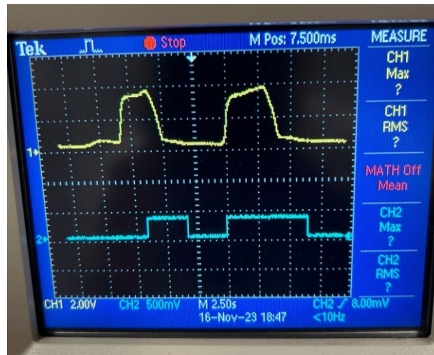
Figura 49 - Canal 1 sensor MQ-6, Canal 2 relé exaustor
