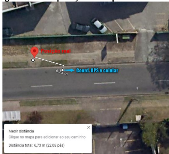
Figura 33: Comparação da imprecisão do GPS
