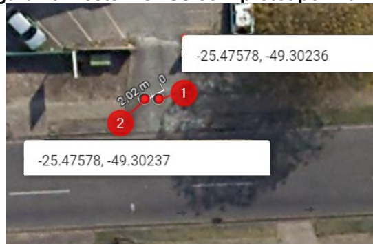
Figura 40: Teste 1 GNSS com protótipo finalizado
