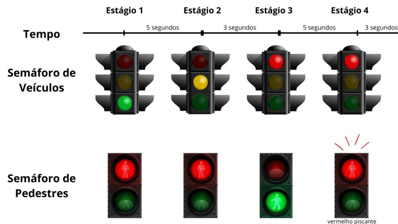
Figura 17: Lógica do semáforo (Ciclo normal)
