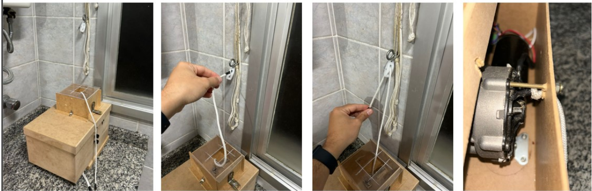
Figura 34 – Passagem da Corda na Roldana e Fixação
