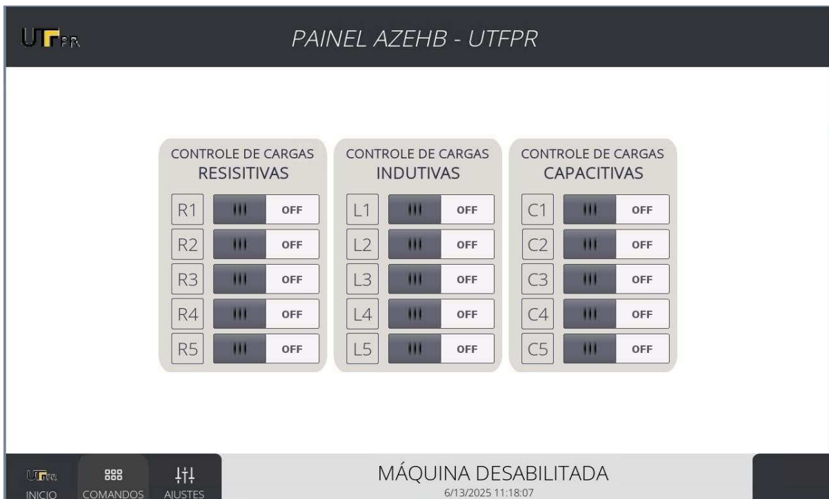
Figura 26 – Interfaces Humano-Máquina dos acionamentos de cargas
