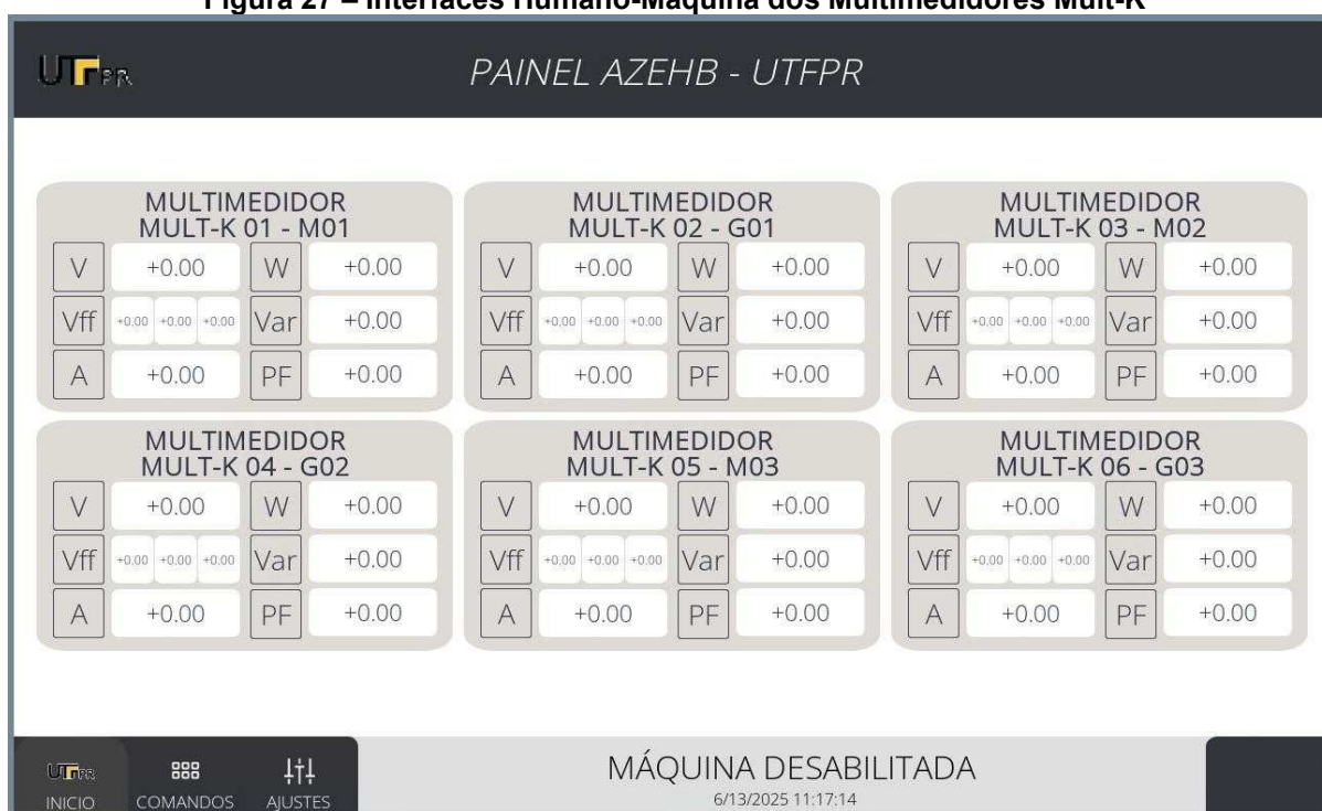
Figura 27 – Interfaces Humano-Máquina dos Multimedidores Mult-K
