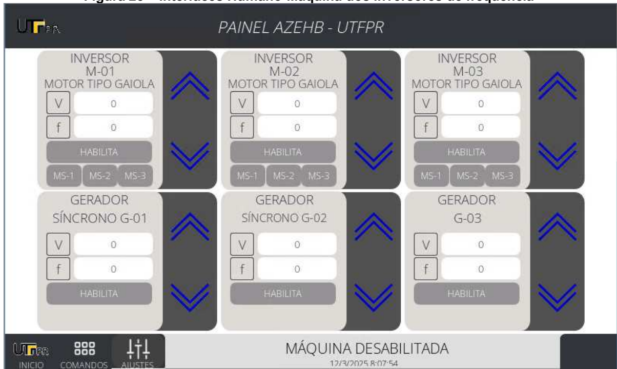
Figura 25 – Interfaces Humano-Máquina dos inversores de frequência
