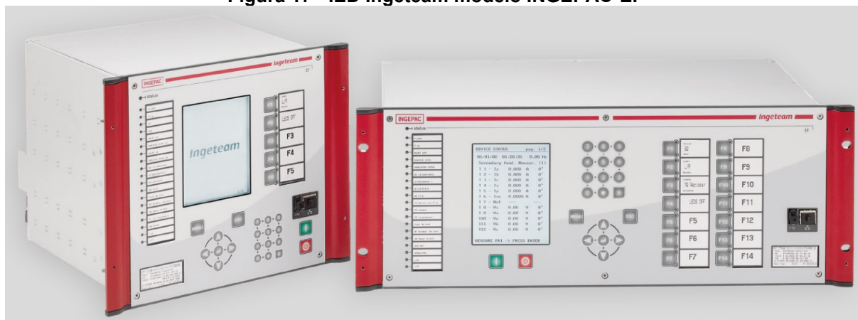
Figura 17 - IED Ingeteam modelo INGEPAC-EF
