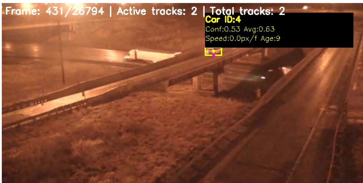
Figura 28 28 - Demonstração de vídeo 21 com baixa visibilidade detectando um veículo
