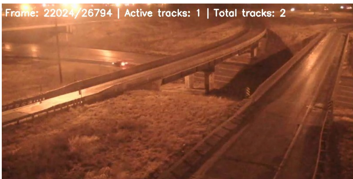
Figura 29 29 - Demonstração de vídeo 21 com baixa visibilidade não detectando um veículo
