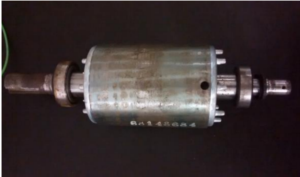
Figura 7 – Rotor com barra perfurada, simulando a quebra
