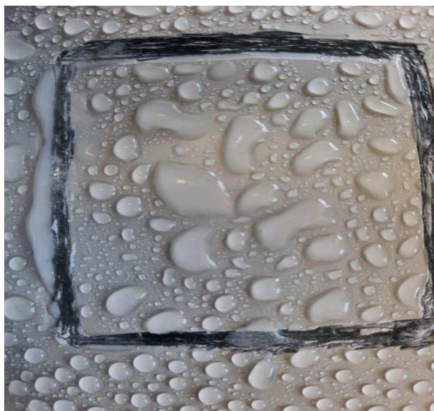
Fotografia 12 – Superfície hidrofóbica de isolador de vidro coberto com silicone RTV
