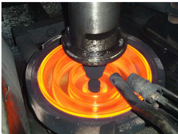
Fotografia 18 – Etapa de prensagem e têmpera na fabricação de isoladores de vidro
