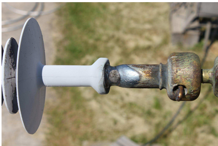
Fotografia 11 – Corrosão e desgaste em ferragem de conexão de isolador
