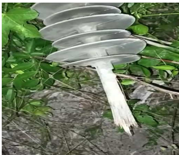
Fotografia 10 – Ruptura mecânica do núcleo de isolador polimérico por tração
