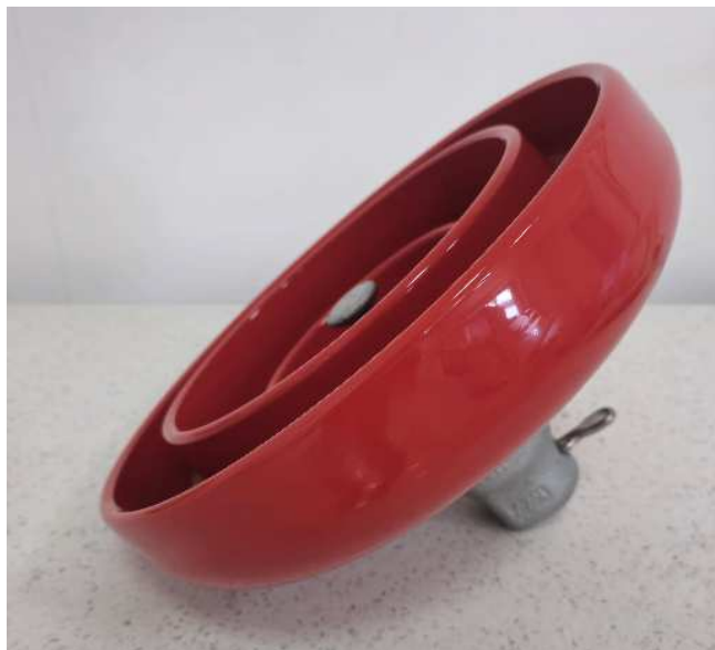
Fotografia 16 – Isolador de vidro revestido com silicone RTV vermelho para ambientes de alta poluição
