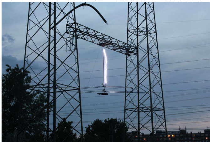
Fotografia 8 – Flashover em isoladores de linha de transmissão durante arco de potência
