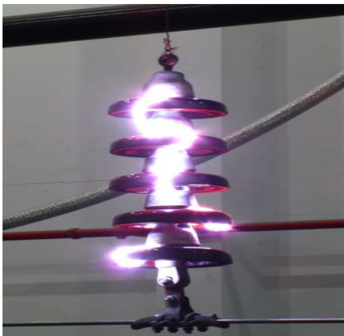
Fotografia 24 – Ensaio de tensão disruptiva em cadeia de isoladores de porcelana
