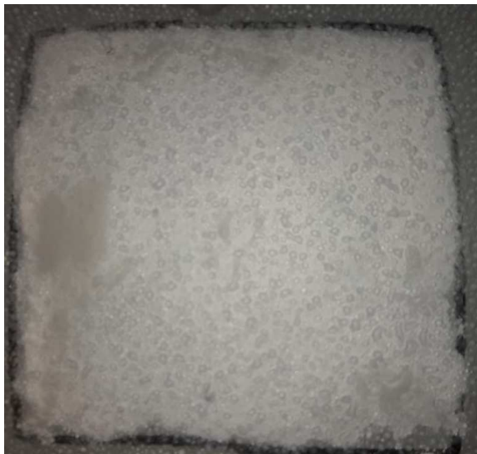
Fotografia 23 – Estudo da ação do RTV de silicone sobre camada poluente em superfície cerâmica
