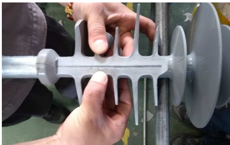
Fotografia 27 – Isolador polimérico após ensaio de aderência entre núcleo e invólucro de silicone
