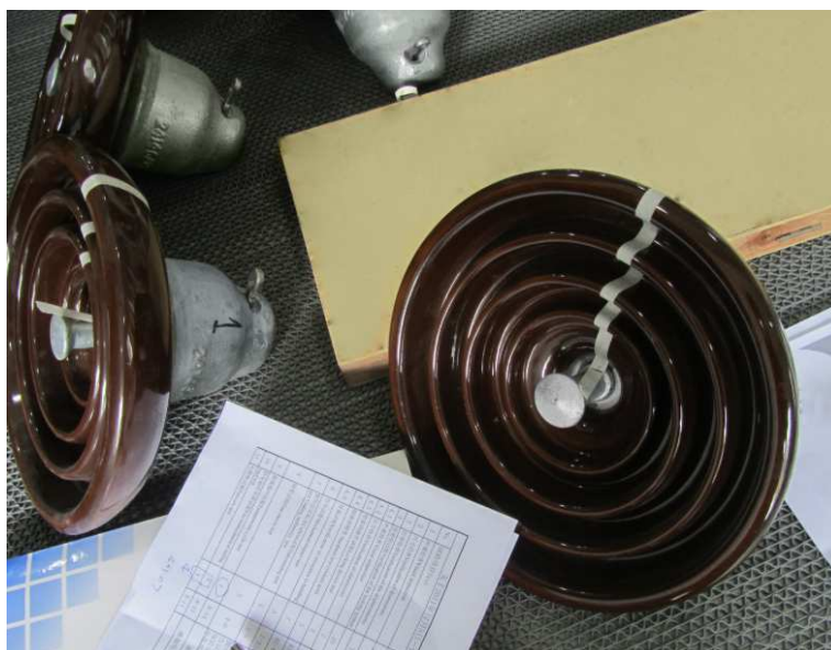
Fotografia 21 – Isolador de porcelana em ensaio de medição da distância de escoamento
