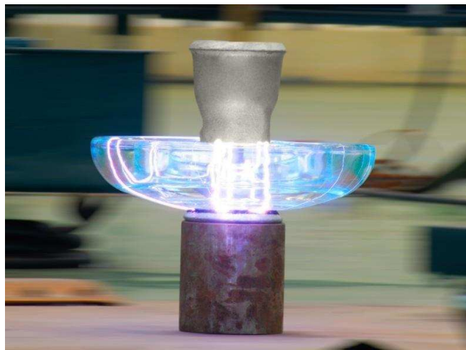
Fotografia 1 - Isolador de vidro sob ensaio de perfuração
