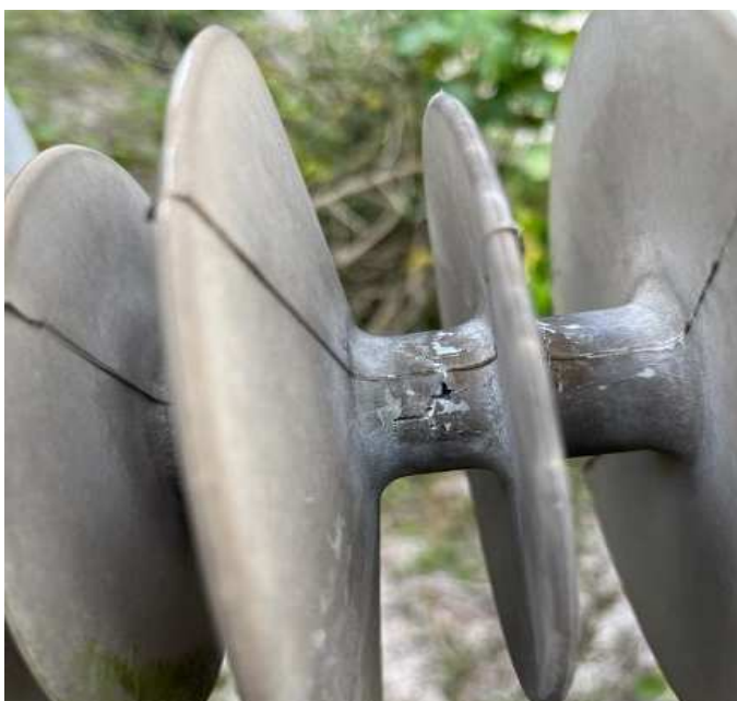
Fotografia 25 – Fratura frágil em isolador polimérico observada em inspeção de campo
