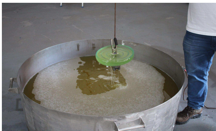
Fotografia 2 - Isolador em ensaio de perfuração no óleo
