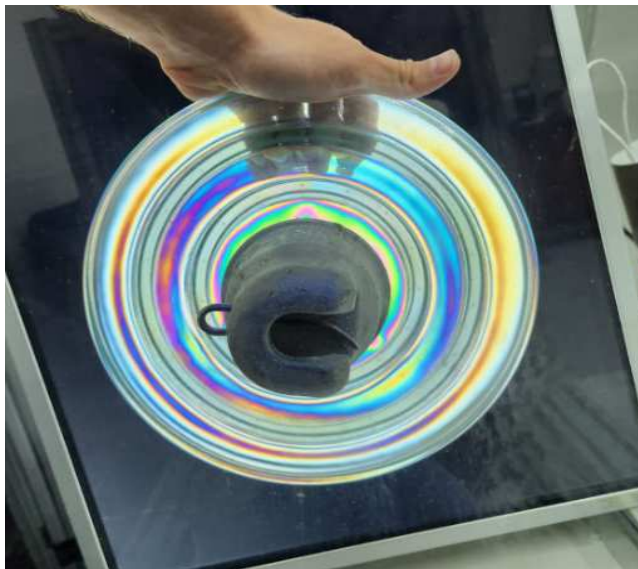
Fotografia 19 – Verificação da têmpera de isolador de vidro em polariscópio, evidenciando distribuição uniforme de tensões internas (boa têmpera)
