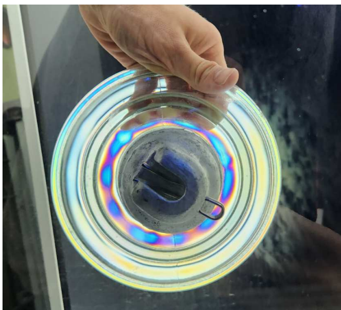
Fotografia 20 – Verificação da têmpera de isolador de vidro em polariscópio, evidenciando distribuição irregular de tensões internas (têmpera ruim)
