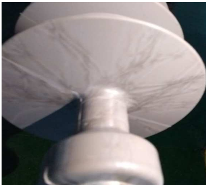
Fotografia 26 – Isolador polimérico após ensaio de tracking e erosão superficial
