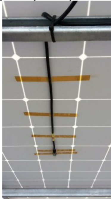
Fotografia 1 - Sensor de temperatura preso na parte traseira de um módulo fotovoltaico
