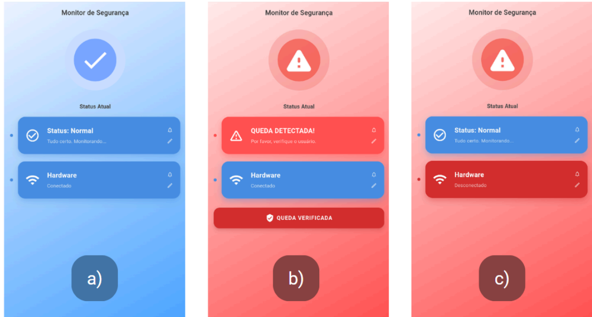
Figura 8 – Dashboard do Monitor de Segurança em três estados: a) operação normal, com hardware conectado e monitoramento ativo; b) queda detectada, exibindo alerta e opção de confirmação da ocorrência; e c) hardware desconectado, indicando perda de comunicação com a smartband.
