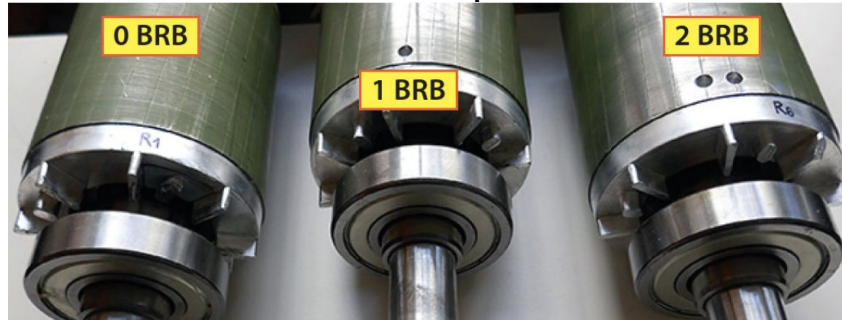
Figura 2 – Rotor Saudável e com Barras Perfuradas para Simular o Defeito de Barras Quebradas
